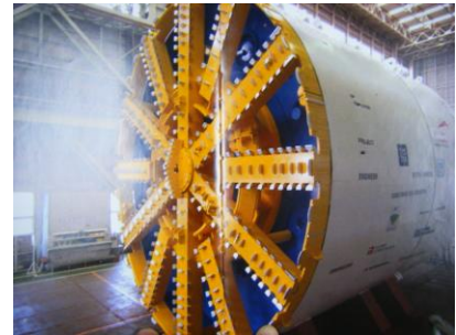
直径6mの掘削機。ドバイ・メトロの地下軌道を掘削した。1km掘って誤差2cm。
